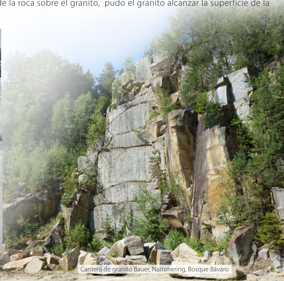
Extracción de grandes bloques mediante una controlada voladura de las grietas
