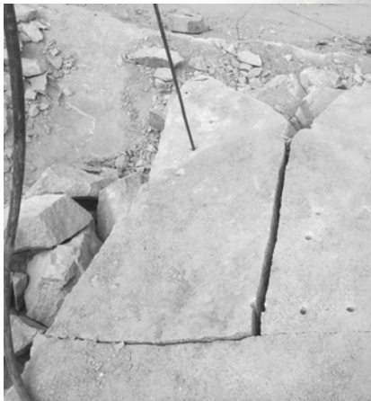
Extracción de grandes bloques mediante una controlada voladura de las grietas
