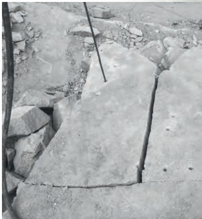
Estrazione dei blocchi di grandi dimensioni mediante granigliatura
